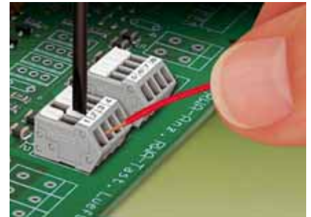
Рис. 12. Клемма серии 218 с зажимом CAGE CLAMP®S. Отвертку использовать не обязательно: движок, сжимающий пружину, можно смещать ногтем
